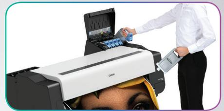
Lại một cải tiến đáng giá khác của Canon được trang bị trên dòng TX, hộp mực phụ. Tất cả mực trong hộp mực chính sẽ được chuyển đến hộp mực phụ trước khi đến đầu in, điều này đồng nghĩa với việc mực in đắt tiền sẽ được sử dụng đến “giọt cuối cùng”, và nhờ có hộp mực phụ mà công việc sẽ vẫn tiếp tục trong khi thay hộp mực mới mà không phải dừng máy phút nào.
